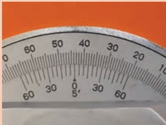
شکل ۱۴- اندازه گیری زاویه باز قطعه کار
