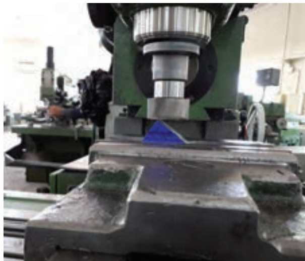
شکل ۱۷- خط کشی و بستن قطعه در گیره
