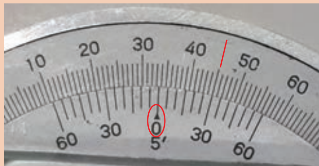
شکل ۱۲- اندازه تنظیمی با زاویه‌سنج
