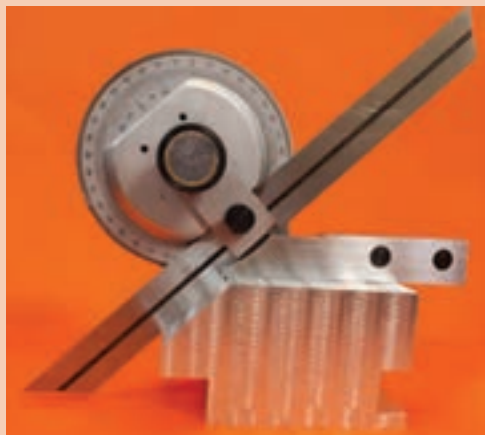
شکل ۱۴- اندازه گیری زاویه باز قطعه کار
